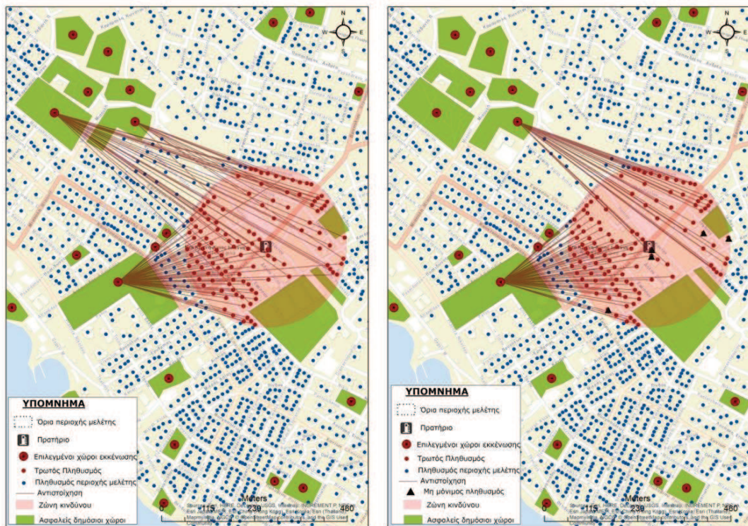
Εικόνα 14: Αντιστοίχιση του πληθυσμού που απειλείται από φωτιά ή/και έκρηξη του πρατηρίου στη θέση επτά προς τους πλησιέστερους ανοιχτούς δημόσιους χώρους, για τις πρωινές (αριστερά) και βραδινές (δεξιά) ώρες.
