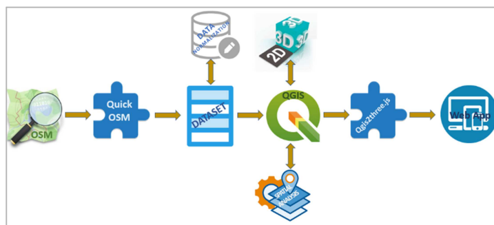
Εικόνα 7: Η Διασωλήνωση (pipeline) των εργασιών
